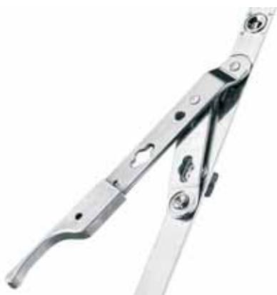
Встроенная защита по смещению подвижной тяги с помощью блокирующей пластины, установленной на шульповой створке, препятствует открыванию шульповой ручки взломщиком уже при базовой безопасности. Удлинитель ручки обеспечивает комфортное управление даже на больших створках и с высоким классом противозломности. Одинаковый порядок работы первой и второй створки обеспечивается идентичными растровыми размерами и позициями запорных пластин.
