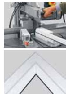
мает измерение углов окна и подгонка штапиков вручную при помощи ножей, напильников и ручных пил при производстве окон нестандартной формы – скошенных, арочных или иных разновидностей.
