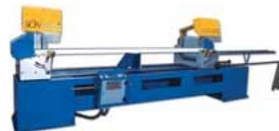
Двухголовая пила PRF 432 для резки профиля с фронтальной подачей диска 420 мм
