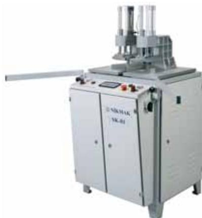
Одноголовая сварочная машина SK-01 с «нулевым швом»
