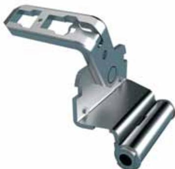
Монтаж ножничной петли происходит путем простого защелкивания в приемную часть ножничного кронштейна и позволяет осуществить легкую фиксацию дужки петли под необходимое исполнение открывания створки. Благодаря возможности использования ножничной петли как для правой, так и для левой стороны обеспечивается оптимизация складских запасов. Интегрированный в петлю тормоз препятствует захлопыванию створки при сквозняке.
