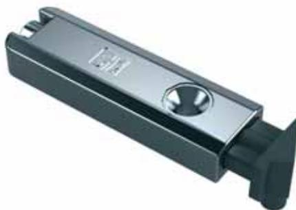
Балконная защелка срабатывает при приотворении створки балконной двери. При переводе ручки в режим «откинута» балконная защелка отключается. В качестве рамной детали применяются стандартные запорные пластины, что способствует сокращению складских запасов.
