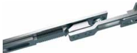
При монтаже на месте присоединения удлинителя детали просто подкладываются и самостоятельно входят в зацепление в правильной позиции. Для универсального сцепления элементов фурнитуры используется только один шуруп для каждого места соединения.
