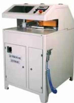
Углозачистной станок STM-01 с системой быстрой смены фрез
