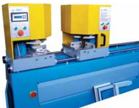
Двухголовая сварочная машина OSM 532, 220 B
