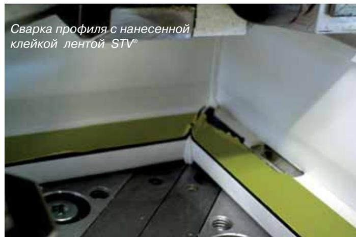
Сварка профиля с нанесенной клейкой лентой STV®
