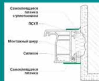
**Схема использования нащельников Bauset SM при монтаже окон без четверти**
