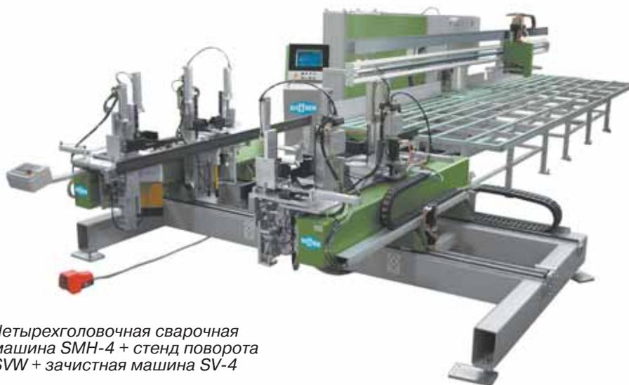
Четырехголовочная сварочная машина SMH-4 + стенд поворота SVW + зачистная машина SV-4
