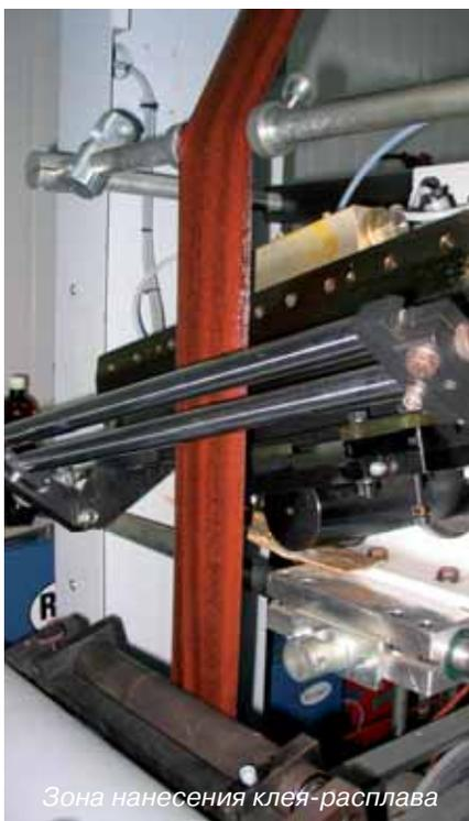
Зона нанесения клея-расплава
