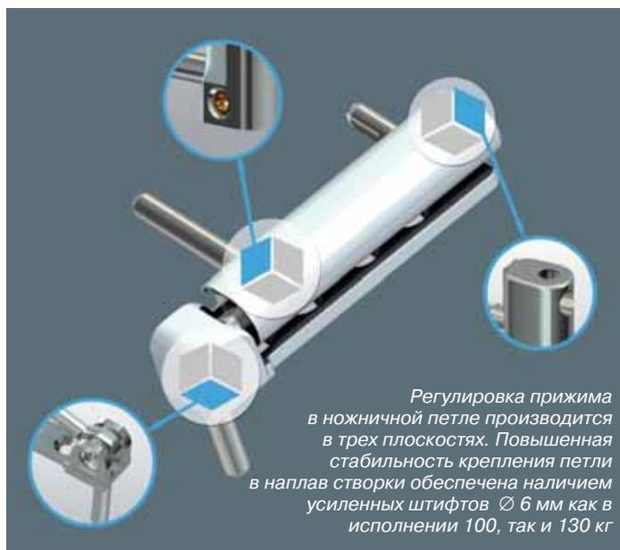
Регулировка прижима в ножничной петле производится в трех плоскостях. Повышенная стабильность крепления петли в наплав створки обеспечена наличием усиленных штифтов  $\varnothing 6$  мм как в исполнении 100, так и 130 кг
