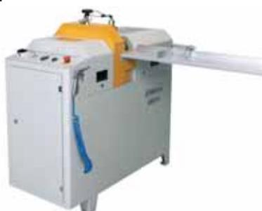
Станок предназначен для автоматической резки штапика под углом 45°. Имеет 2 режущих и 2 подрезных диска.
