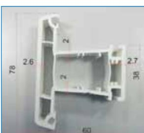
■ Толщина стенок профиля колеблется от 2 до 2,8 мм.
