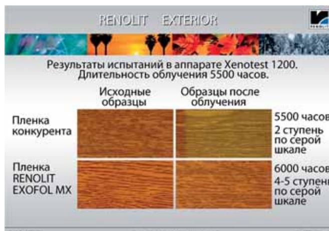
*Контрольные образцы оригинальной пленки RENOLIT и пленки, имитирующей характеристики пленки RENOLIT, произведенной недобросовестным конкурентом, до и после облучения в аппарате Xenotest*
