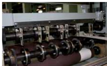
парениями изолированы, что позволяет сохранить здоровье персонала. Башмаки для нанесения праймера устанавливаются в уникальную пружинную систему, гарантирующую ровное нанесение праймера по всей поверхности в течение 16 часов непрерывной работы. Уникальные удобные и легкие ракель (устройства для нанесения клея) изготовлены из хирургической стали и доказали свою надежность за 7 лет работы на установке УЛП-500.
