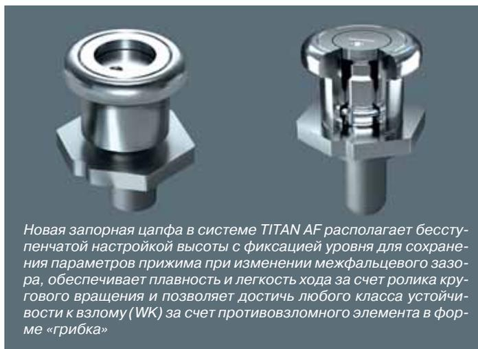
Новая запорная цапфа в системе TITAN AF располагает бесступенчатой настройкой высоты с фиксацией уровня для сохранения параметров прижима при изменении межфальцевого зазора, обеспечивает плавность и легкость хода за счет ролика кругового вращения и позволяет достичь любого класса устойчивости к взлому (WK) за счет противовзломного элемента в форме «грибка»
