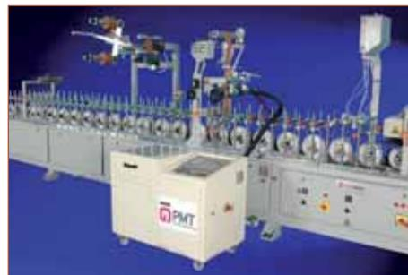
Рис. 3. Станок для ламинирования с использованием полиуретанового клея-расплава
