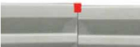
В случае перепада высоты свариваемых заготовок профиля, который связан с допусками экструзии, встроенные измерительные системы определяют среднюю высоту сварки, а также точку стыковки двух заготовок профиля, автоматически компенсируя разницу между двумя профилями до 0,7 мм по высоте профиля. В случае больших различий машина запрашивает подтверждение оператора, чтобы продолжить процесс сварки.
