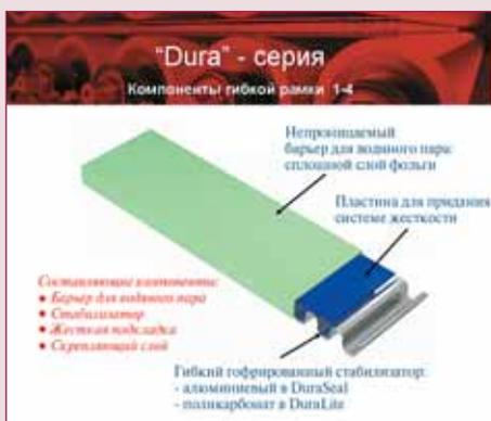
В DuraLite вместо волнообразного алюминиевого разделителя применен поликарбонат. Это значительно снижает коэффициент теплопроводности, делая DuraLite лидером среди других систем «теплого края».
