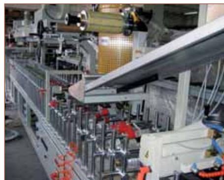
Рис. 2. Подача шпона на станок для ламинирования
