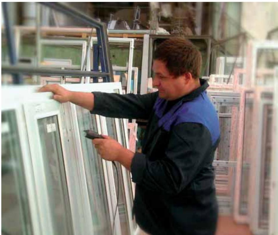
*Последний этап производства после остекления окон заканчивается сканированием штрихкода (фото «ВинДор»)*
