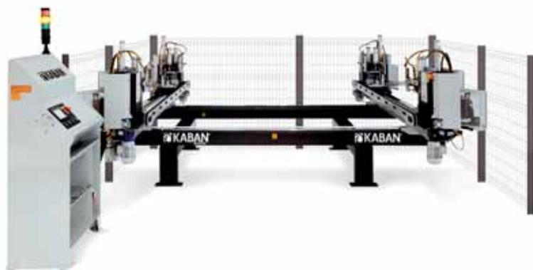
BD 2030. Четырехголовочный сварочный станок Kaban Makina.
