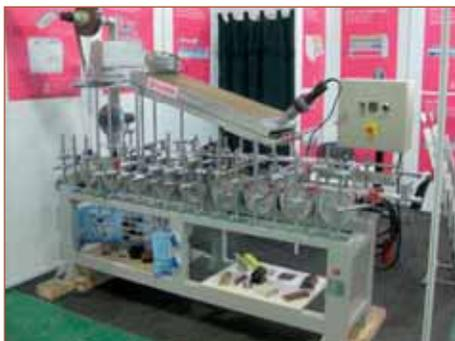
Рис. 7. Мини-станок для ламинации
