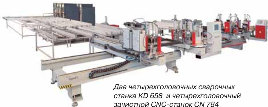
Два четырехголовочных сварочных станка KD 658 и четырехголовочный зачистной CNC-станок CN 784
