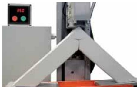
Каждый профиль ПВХ имеет собственные характеристики прочности углового сварного соединения, что определяется составом, конфигурацией профиля, а также качеством процесса сваривания. Новая сварочная машина SL4 FF обеспечивает более высокие значения по прочности углового соединения в сравнении с ЛЮБОЙ сварочно-зачистной линией классического исполнения.
