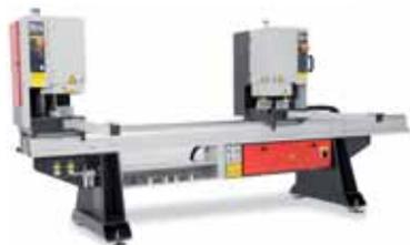
*МА 2010. Двухголовочный сварочный станок Kaban Makina.*
