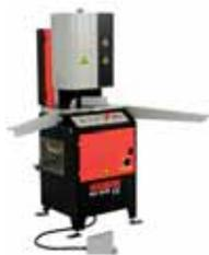
*ВА 2030. Одноголовочный сварочный станок Kaban Makina.*
