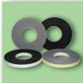
Защита внешнего контура шва. Защищает утеплитель от неблагоприятных воздействий, таких как дождь, снег, пыль, Уф-излучения. Также лента ПСУЛ способна выводить влагу, проникающую в монтажный шов, наружу.
