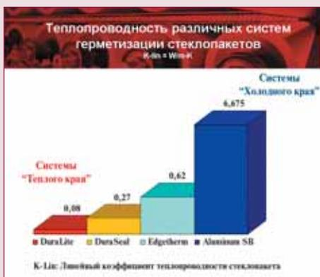
Не требующая вторичной герметизации система DuraLite благодаря своей «утепленной» структуре повышает температуру в краевой зоне стеклопакета на 5-7°C, обеспечивая более «теплую» герметизацию и снижая возможность образования конденсата более чем на 80%.
