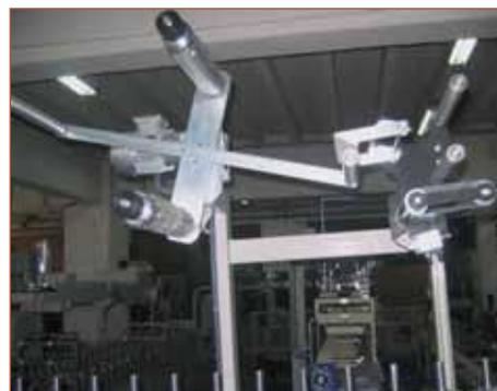
Рис. 4. Система автоматической смены пленки
