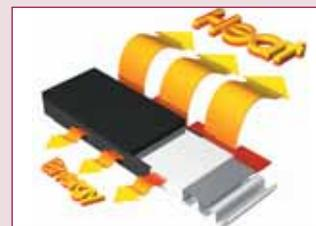
Использование гибких рамок «теплого края» значительно снижает потери тепла по сравнению с алюминиевыми рамками
