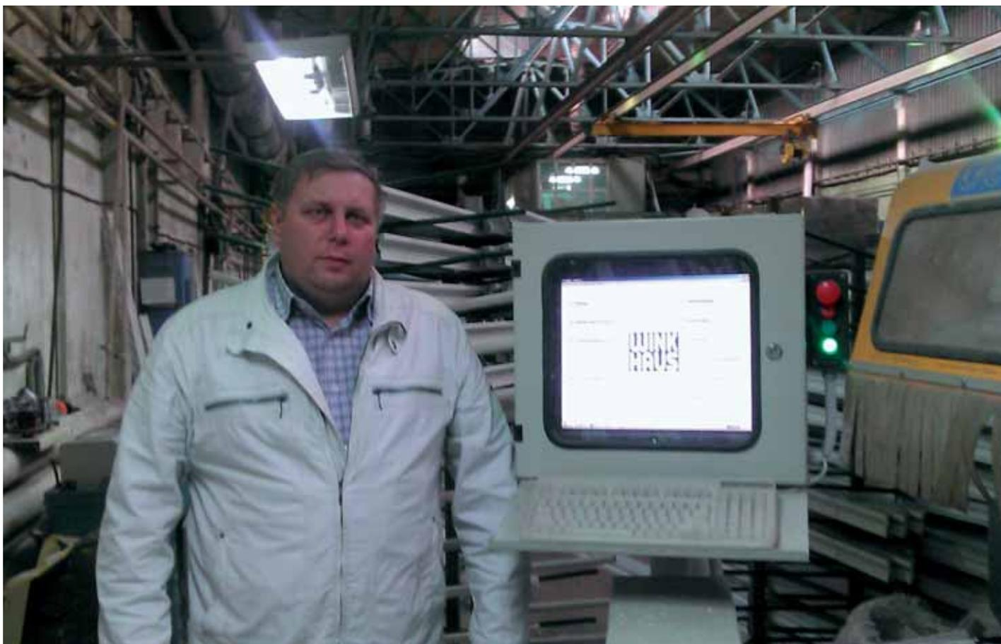
*Характерным элементом системы WH Net являются мониторы, размещенные на отдельных рабочих участках производства окон (фото «ВинДор»)*
