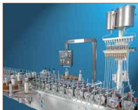
Рис. 5. Станок для одновременного двухстороннего ламинирования
