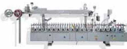
*Рис. 1. Станок Plasmek LM 300 W6S для ламинирования ПВХ- и алюминиевых профилей с использованием двухкомпонентного клея холодного отверждения*
