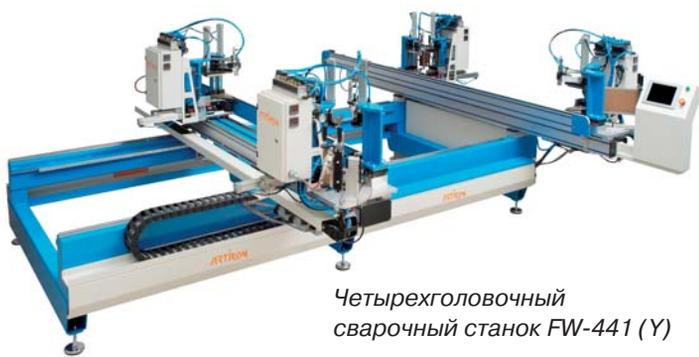
Четырехголовочный сварочный станок FW-441 (Y)
