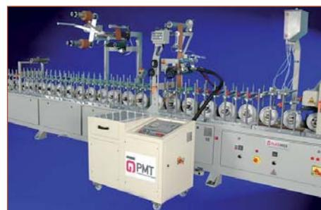
Станок для ламинирования с использованием полиуретанового клея-расплава
