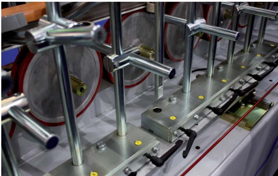
*Механическая система высвобождения штанг с прикатывающими роликами*
