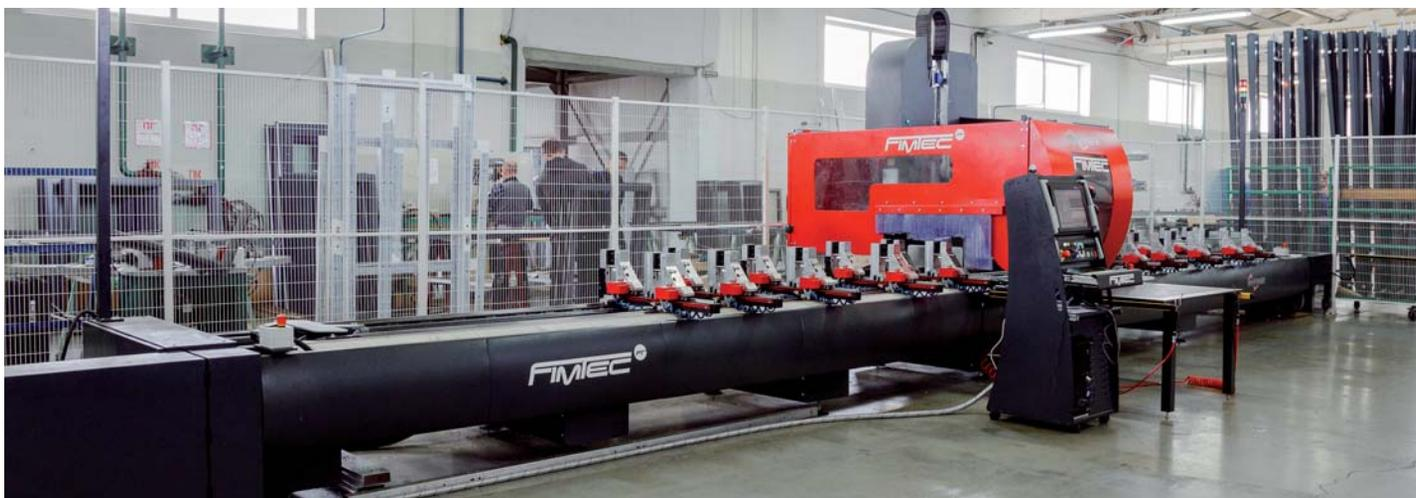
*Автоматический обрабатывающий центр для легкосплавных и стальных профилей METALFAB 52*
