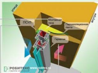
Применение ленты ПСУЛ Робибанд на внешнем контуре оконных конструкций для защиты утеплителя внутри монтажного шва от внешних неблагоприятных воздействий: дождя, УФ-излучения и других.
