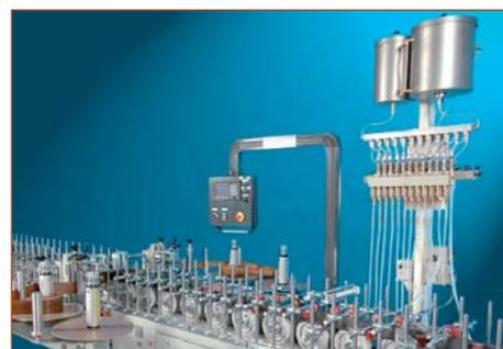
*Система автоматизированной подачи праймера на станке*
