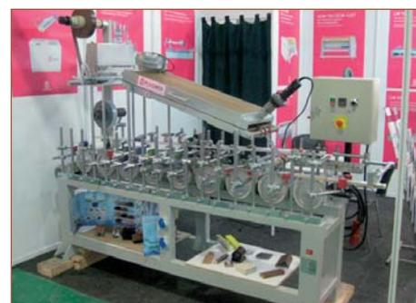
Мини-станок для ламинации. Скорость ламинирования до 10 м/мин
