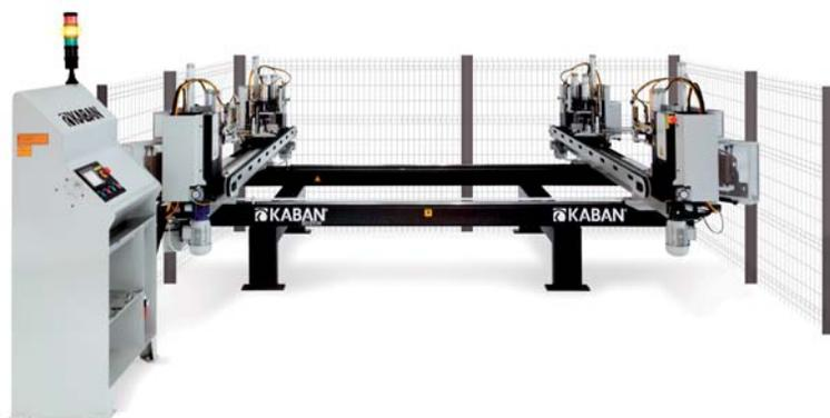
BD 2030. Четырехголовочный сварочный станок Kaban Makina.
