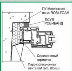
Применение материалов при монтаже светопрозрачных конструкций с последующим оштукатуриванием откосов.
