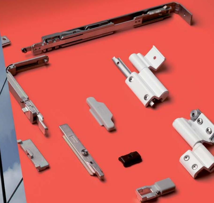
Новый инновационный поворотно-откидной механизм для профилей с европазом в двух исполнениях: на **110 кг** и на **130 кг**. Механизм предоставляет 3D-регулировки: горизонтальную, вертикальную и на прижим. Петли могут быть покрашены или анодированы. Петли для второй створки полностью идентичны по своему дизайну с петлями поворотно-откидного механизма.
