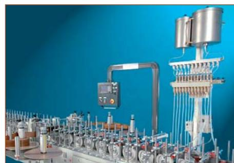
*Система автоматизированной подачи праймера на станке*
