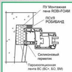
Применение материалов при монтаже светопрозрачных конструкций с последующей отделкой откосов панелями.
