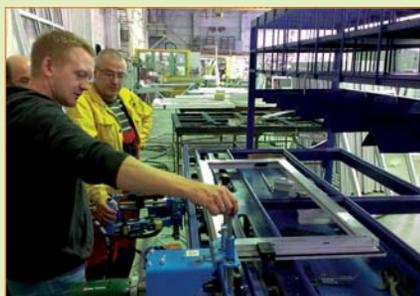
Наряду с инновационными разработками в области оконной и дверной фурнитуры компания Winkhaus придает большое значение функциональным решениям для оптимизации и автоматизации производства окон, одно из них – фурнитурный стол WNK 2300, разработанный компанией Winkhaus для повышения автоматизации производства и увеличения производительности.
