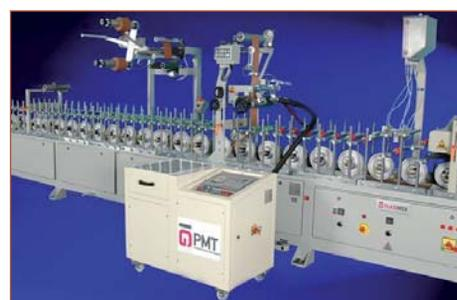
Станок для ламинирования с использованием полиуретанового клея-расплава
