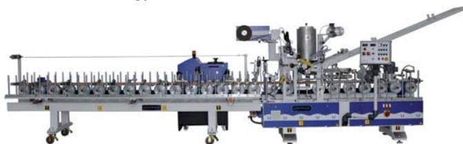
Станки типа PW35F55-PC / PW35F65-PC разработаны для облицовки профилей из дерева, ДВП, МДФ, рам и наличников полипропиленом (ПП), бумагой (финиш-пленкой), ПВХ-пленкой, рулонным шпоном и меламином (опционально). Максимальная ширина пленки 350 мм. Скорость ламинации 10 – 60 м/мин.
