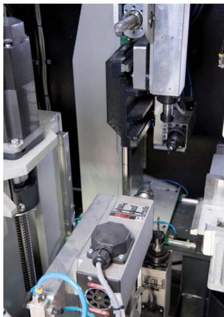
Благодаря 7-осному серводвигателю выполняется фрезеровка на 4-х поверхностях профиля, высокая скорость вращения 18000 об/мин обеспечивает чистоту операций. Полное время обработки заготовки от 10 до 17 секунд, в зависимости от заданного количества операций.
