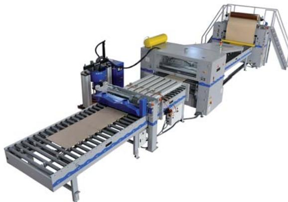
В стандартную комплектацию линии входят: конвейер подачи панелей, оборудование для очистки поверхности заготовок, узел предварительного обогрева панелей, отдел подготовки и подачи клея, станок нанесения клея на поверхность, подставка для подачи листов, роликовый пресс, размоточный узел и конвейер приема панелей. Скорость каширования 5 – 25 м/мин.
