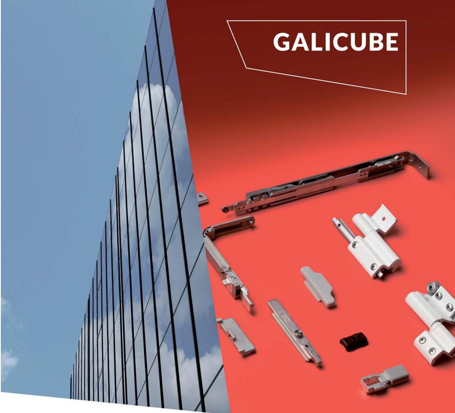
Новый инновационный поворотно-откидной механизм для профилей с европазом в двух исполнениях: на **110 кг** и на **130 кг**. Механизм предоставляет 3D-регулировки: горизонтальную, вертикальную и на прижим. Петли могут быть покрашены или анодированы. Петли для второй створки полностью идентичны по своему дизайну с петлями поворотно-откидного механизма.
