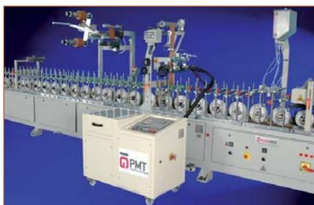
Станок для ламинирования с использованием полиуретанового клея-расплава
