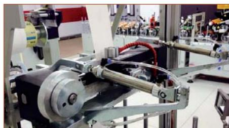
6. Новая клеевая голова PSN-301 была разработана с целью легкой очистки фильтра. Кроме этого, разработано специальное предохранительное устройство для предотвращения закупоривания фильтров в случае высокого давления клея. Раньше при повышении давления была вероятность повреждения самого фильтра, крышки и соединения шланга.
