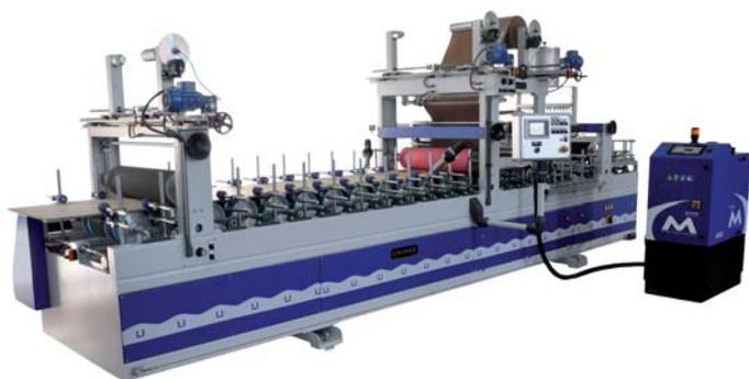
Станок укомплектован плавильной системой фирмы «Мелтон» (Испания) для плавления и нанесения клея-расплава. Максимальная ширина нанесения клея 550/850/1100/1300 мм.
