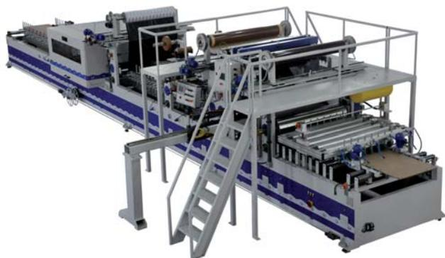
FLL1400PUR-SA – линия для каширования ровных поверхностей декоративными и глянцевыми пленками с использованием ПУР-клея-расплава.
