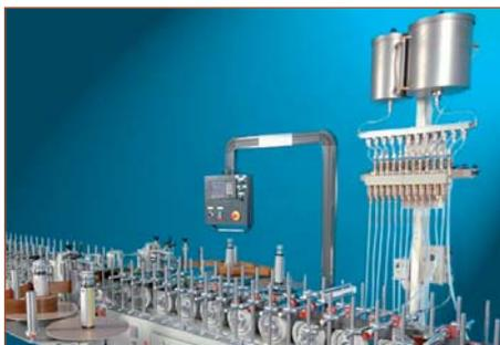
Система автоматизированной подачи праймера на станке
