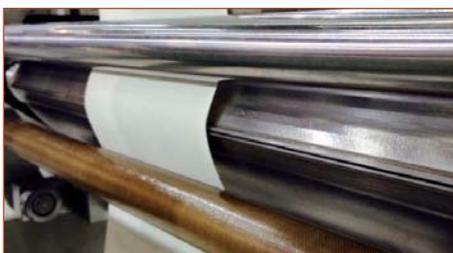
2. Прежняя система нанесения клея PSN-300 открывалась симметрично от центра, а новая клеевая голова PSN-301 может регулироваться как левую, так и правую стороны независимо друг от друга. Это обеспечивает свободу в использовании и возможность настройки под определенный вид и конфигурацию профиля. Система упростит настройки при ламинации наличников и дверных коробок.
