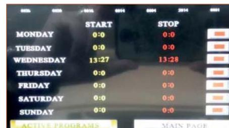
Например, если рабочий день начинается в 9 часов, то операционист может запрограммировать начало работы плавильника на 8:30 утра. Ровно в это время плавильник автоматически включится и начнет подготовительный прогрев всей плавильной системы. К 9:00 клей будет уже расплавлен, станок прогрет и готов к работе.
