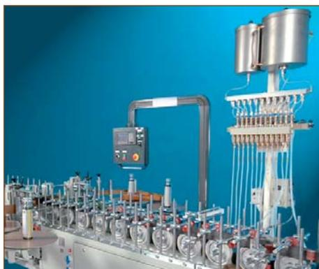
Система автоматизированной подачи праймера на станке
