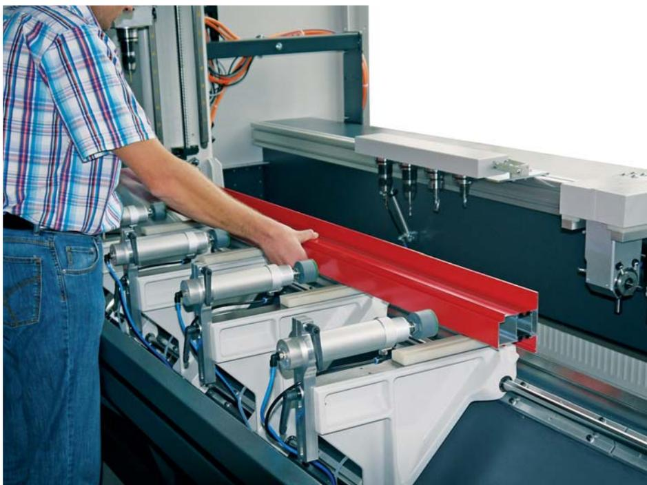
Новая конструкция станины не дает стружке скапливаться в зоне обработки
