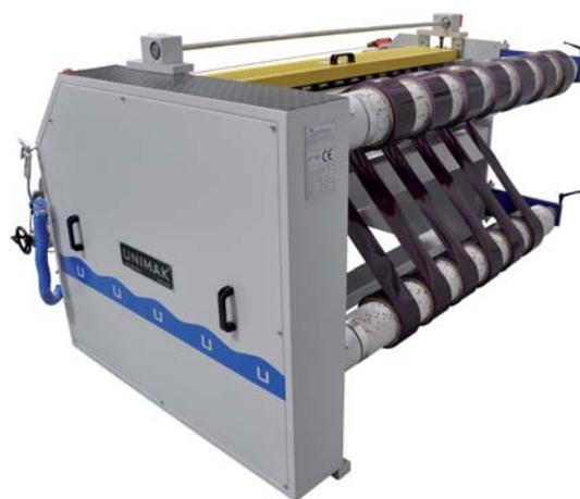
Скорость резки достигает 75 м/мин.
