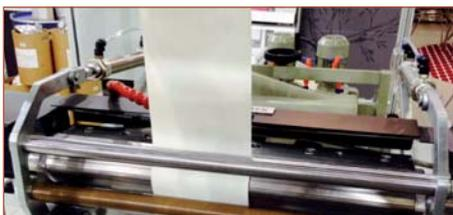
4. Для управления потоком клея во время остановки станка в конструкцию щелевой головы добавлен электропневматический клапан.
