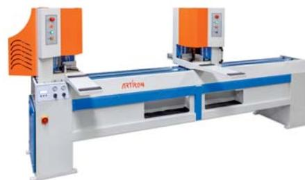
DW-241. Двухголовый сварочный станок
