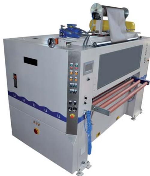
Компактная конструкция высокой производительности с вальцовой системой нанесения клея-расплава на поверхность панелей (МДФ, ДСП, массив древесины, ПВХ, алюминиевые плиты, гипсокартон и т. д.) с одновременным прикатыванием облицовочных материалов.
