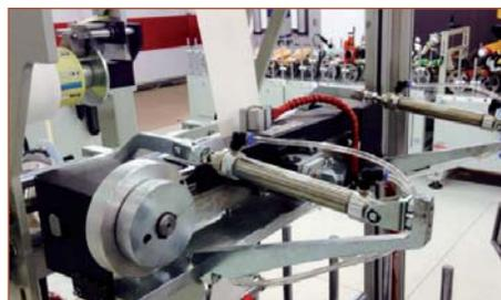
6. Новая клеевая голова PSN-301 была разработана с целью легкой очистки фильтра. Кроме этого, разработано специальное предохранительное устройство для предотвращения закупоривания фильтров в случае высокого давления клея.
