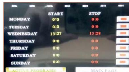
Например, если рабочий день начинается в 9 часов, то операционист может запрограммировать начало работы плавильника на 8:30 утра. Ровно в это время плавильник автоматически включится и начнет подготовительный прогрев всей плавильной системы. К 9:00 клей будет уже расплавлен, станок прогреет и готов к работе.
