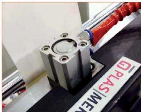
5. Равномерный прогрев клеевой головы. Определяется с помощью встроенной термомпары, которая четко показывает температуру в любой области щелевой головы и выносит данные на PLC.
