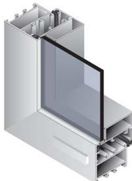
Система СИАЛ Слайдинг-45 – симбиоз систем СИАЛ КП45 и СИАЛ Слайдинг-60. Позволяет монтировать раздвижные створки, выполненные из профилей системы СИАЛ Слайдинг-60, в витраж системы СИАЛ КП45 без использования профилей рамы, т. е. без изменения толщины конструкции.
