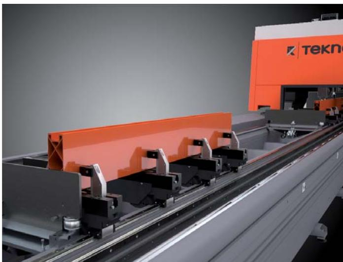
*ТКЕ 984/ТКЕ 985 позволяют обрабатывать профили большого сечения с 5 сторон*
