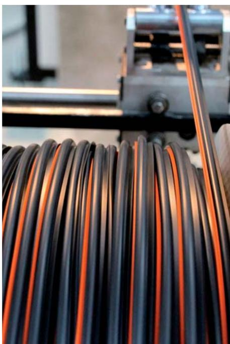
гозатратный процесс, требующий также больших капиталовложений. Помимо изготовления профиля в специальном экструдере, требуется непрерывная вулканизация получаемого уплотнителя. Все это приводит к тому, что цена EPDM-уплотнителей высока. Дешевые EPDM-уплотнители содержат мало каучука, много сажи и имеют низкие деформационно-прочностные характеристики и показатели долговечности.
