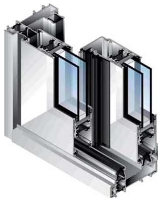
Система предназначена для изготовления «теплых» раздвижных окон, дверей и небольших витражей. Раздвижная конструкция может сочетаться с глухими участками и распашными створками. Толщина конструкции составляет 106 мм. Изделия гарантируют оптимальную тепло- и звукоизоляцию, обеспечивают отличную воздухо- и влагонепроницаемость. Рамы легко монтируются в фасадные системы и могут быть встроенной частью единого светопрозрачного фасада.
