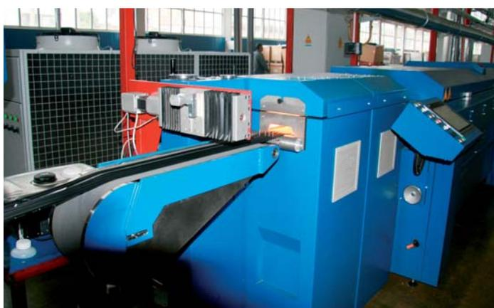
Повторная и окончательная вулканизация производится на заключительной стадии с помощью СВЧ-излучения на следующем участке линии. Уплотнительный профиль равномерно прогревается по всей глубине, что позволяет выпускать стабильную геометрию уплотнителей любой толщины. После окончательного формирования геометрии профиль поступает на участок охлаждения, где уплотнитель охлаждается с помощью водяных форсунок до комнатной температуры.
