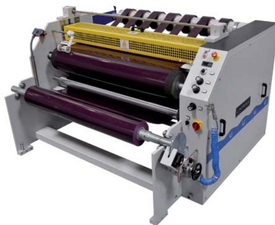
Простота в использовании, высокое качество резки и намотки пленки являются их характерными свойствами. Благодаря фрикционным осям для намотки нарезанной пленки, которые состоят из автономно вращающихся колец, тяга нарезанных полос пленки поддерживается на равном уровне. Режущие инструменты – верхние и нижние дисковые ножи.
