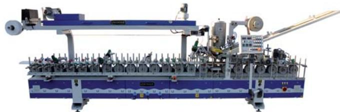
Станок разработан для облицовки профилей из дерева, ДВП, МДФ, рам и наличников полипропиленом (ПП), бумагой (финиш-пленка), ПВХ-пленкой, рулонным и листовым шпоном. На станке используется система нанесения для клея ЭВА/ПО и двухкомпонентного клея на основе растворителя.
