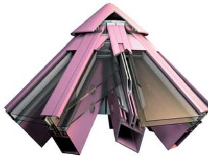
Это базовая серия, которая предназначена для изготовления легких навесных стеновых ограждений зданий, а также наклонных светопрозрачных покрытий, фонарей, зимних садов и других пространственных конструкций. В состав несущей конструкции входят вертикальные (стойки) и горизонтальные (ригели) элементы с видимой шириной 50 мм, которые соединяются между собой методом наложения ригеля на стойку.
