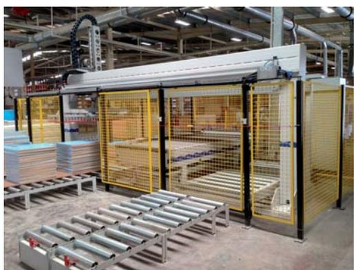
Максимальная ширина панелей до 1300 мм. Оборудование предназначено для ламинации МДФ-панелей декоративными и глянцевыми пленками с использованием ПУР-клея-расплава.
