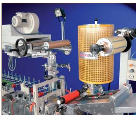
EVA и двухкомпонентная холодная система
