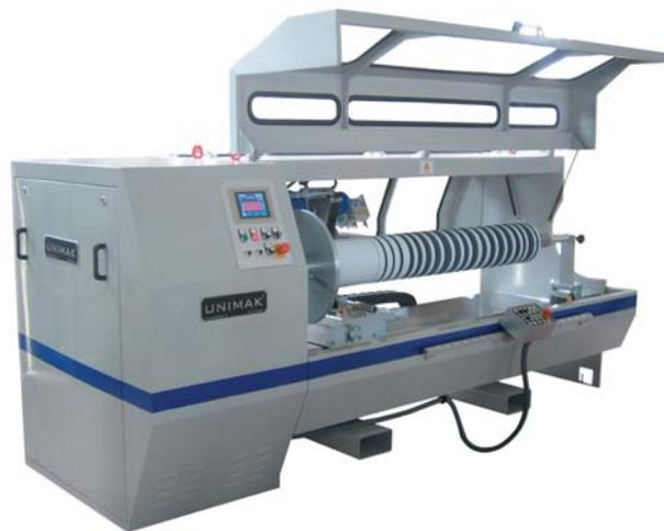
Станок для резки защитной пленки с сервоконтролем в 3-х осях без образования стружки и отходов. Предназначен для резки защитной пленки, маскировочных и двухсторонних клейких лент различной толщины с помощью пилы или дискового ножа. Благодаря точности расчетов специалистов и качественному производству оборудования погрешность нарезки составляет всего 0,1 мм.
