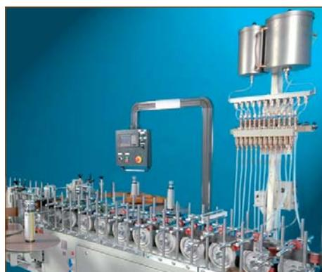
Система автоматизированной подачи праймера на станке
