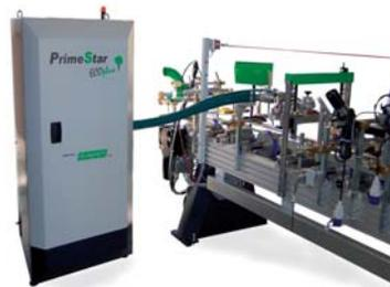
Установка для нанесения праймера PrimeStar 2010 разработана для оптимальной дозировки водных праймеров с малым содержанием ЛОС. Технология очистки ЕСОplus сокращает образующиеся в результате использования растворителей эмиссионные показатели приблизительно на 90%, а также обеспечивает постоянное качество склеивания и чистоту установки. PrimeStar 2010 является модульной системой оснащения для любой ходовой облицовочной установки и легко поддается модернизации.
