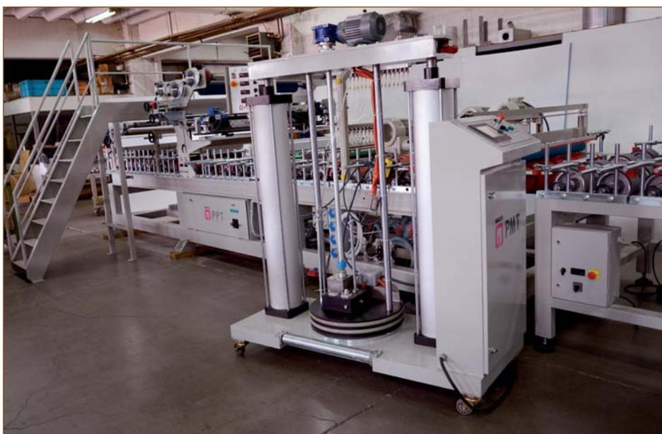
Ламинационный станок на клеe-расплаве (бочковой плавильник под 200 кг фасовку клея) для профилей шириной до 1000 мм
