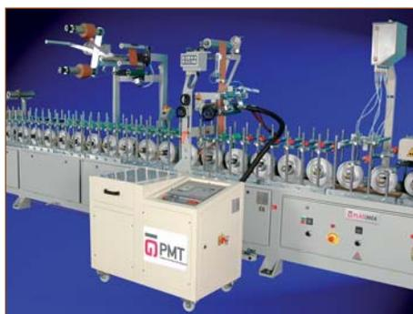
Ламинационный станок для ПВХ- и алюминиевых профилей, работающий на ПУР-клею-расплаве, модель LM300-W6-Pur
