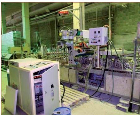
Китайский ламинационный станок с шириной ламинации до 900 мм, переделанный под ПУФ-систему
