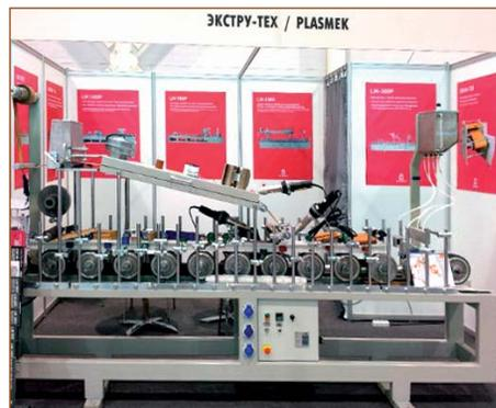
Мини-станок для ламинации. Скорость ламинирования до 12 м/мин
