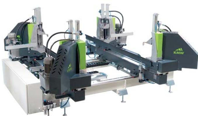
Одной из главных особенностей гидравлической сварочной машины нового поколения является возможность обработки лицевых поверхностей, как например: отделка под натуральное дерево, ламинация, матовые (как у профилей Veka Spectral), акриловые и другие покрытия.
