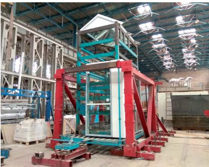
Специалистами лаборатории были протестированы различные режимы ускорений виброплатформы с подбором резонансных частот, «...полученные значения горизонтальных ускорений превышают значения нормативных ускорений, соответствующих 9 баллам, в 3 раза» (ускорения фрагментов образцов в уровне зенитного фонаря — до 13,6 м/с<sup>2</sup>, а требование соответствия 9 баллам по шкале MSK-64 — 4 м/с<sup>2</sup>).
