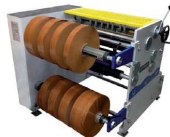
Простота в использовании, высокое качество нарезки и намотки пленки являются их характерными свойствами. Легко настраиваемые режущие инструменты (лезвия) прослужат долго благодаря двухстороннему использованию. Они доступны для замены на рынке и не требуют таких финансовых затрат, как дисковые ножи.
