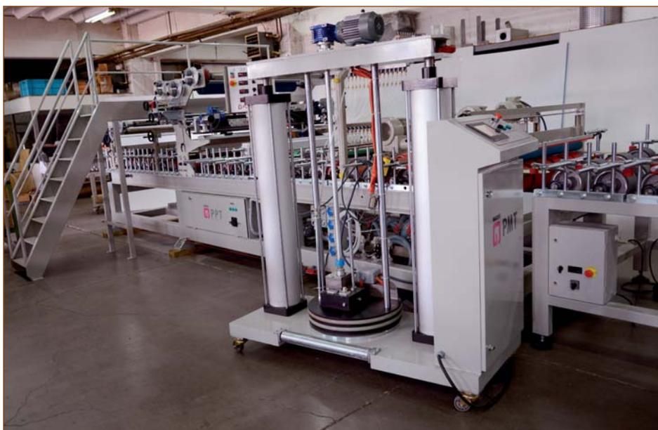
Ламинационный станок на кле-расплаве (бочковой плавильник под 200 кг фасовку клея) для профилей шириной до 1000 мм
