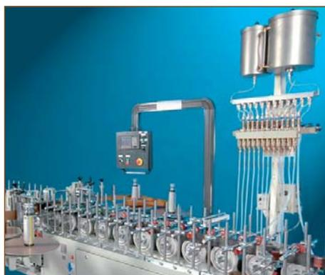
Система автоматизированной подачи праймера на станке
