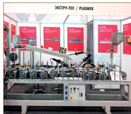
*Мини-станок для ламинации. Скорость ламинирования до 12 м/мин*
