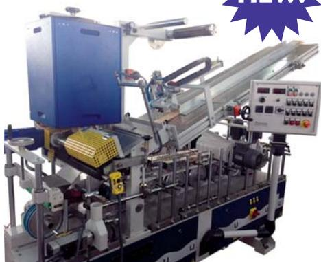
Ламинирующий станок для профилей с использованием роликового нанесения термоплавок клеев на основе полиуретана (PUR), ЭВА и полиолефина (АРАО) со сменной кассетной конструкцией. Станок укомплектован плавильной системой собственного производства.
