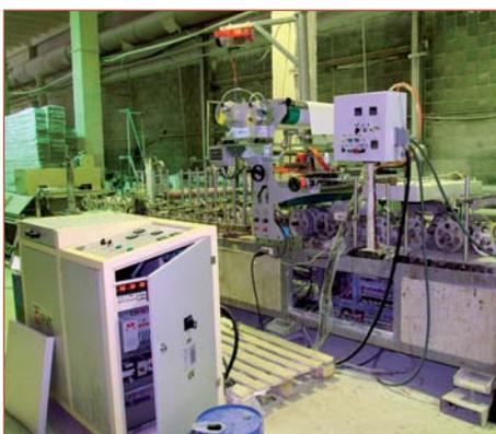
*Китайский ламинационный станок с шириной ламинации до 900 мм, переделанный под ПУР-систему*
