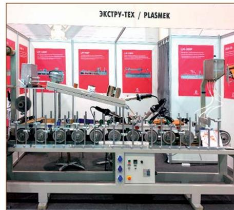
Мини-станок для ламинации. Скорость ламинирования до 12 м/мин
