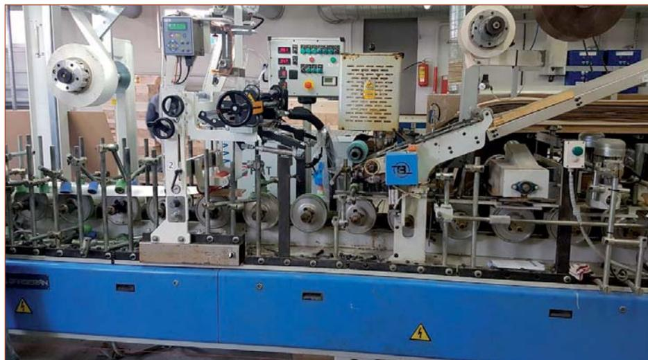
Переоборудование компанией «Экстру-Тех» ламинатора Barberan на ПУР-систему
