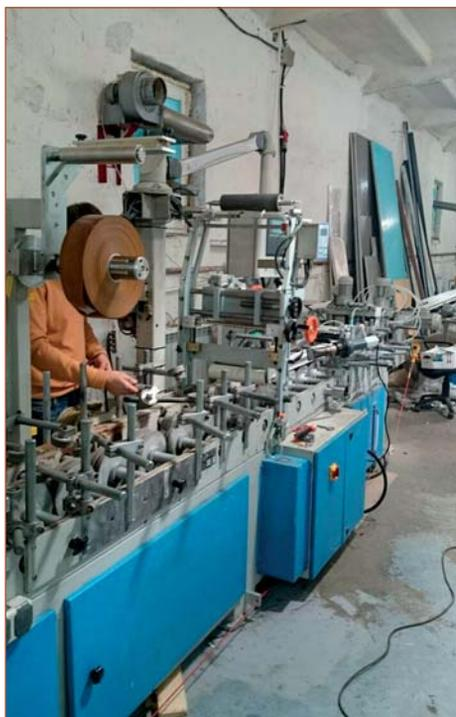
Переоборудование компанией «Экстру-Тех» ламинатора FUX на ПУР-систему
