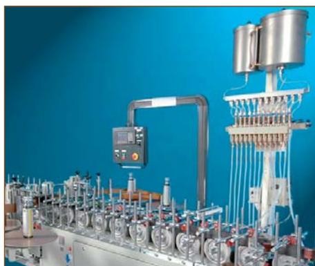
Система автоматизированной подачи праймера на станке
