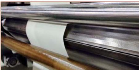
2. Предыдущая щелевая голова PSN-300 открывалась симметрично от центра, а новая модификация щелевой головы PSN-301 может регулировать как левую, так и правую стороны независимо друг от друга. Это обеспечивает свободу в использовании и возможность настройки под определенный вид и конфигурацию профиля (например, ширина профиля разная, а геометрия одинаковая). Система упростит настройки при ламинации наличников и дверных коробок.
