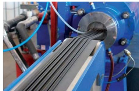
Метод производства монолитных неформовых профилей на экструзионной вулканизационной линии является перспективным, линия позволяет выпускать профили любой сложности.
