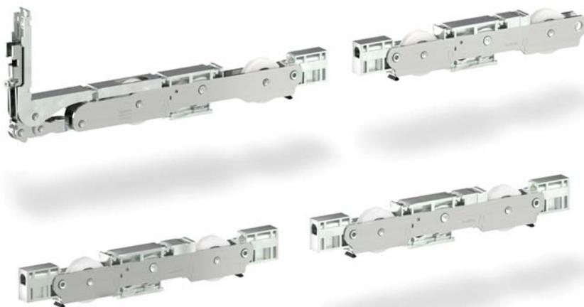
Когда створка находится в закрытом положении, нагрузка переносится с роликов на подшипники роликов, для предотвращения деформации из-за статической нагрузки. Механизм роликов выполнен таким образом, чтобы противостоять ветровой нагрузке и покрыт устойчивой к царапинам полиамидной оболочкой для сохранения правильной формы направляющей в зоне поддержки. Установленные щетки очищают зону контакта роликов с направляющей, обеспечивая всегда плавный ход створки.
