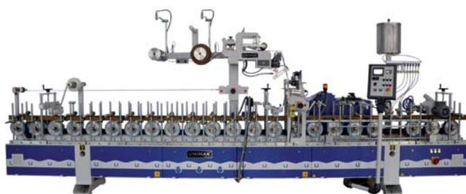
Рабочая длина станка (5 м) имеет достаточное пространство для деионизации и сдува пыли, а также нанесения праймера на поверхность профиля и ее тщательной осушки.
