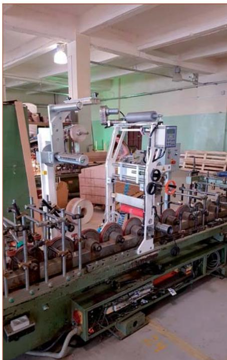
Переоборудование компанией «Экстру-Тех» ламинатора FRIZ на ПУР-систему
