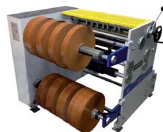
Для данного типа станков характерны простота в использовании, высокое качество нарезки и намотки пленки. Легко настраиваемые режущие инструменты (лезвия) прослужат долго благодаря двухстороннему использованию. Они доступны для замены на рынке и не требуют таких финансовых затрат, как дисковые ножи.
