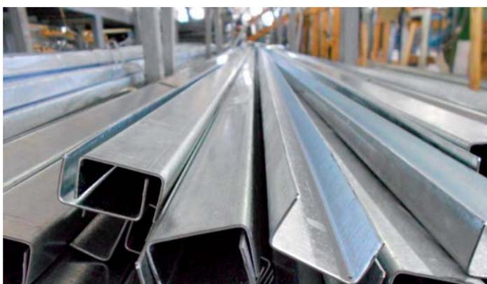
Армирующий профиль защищен оцинкованным покрытием
