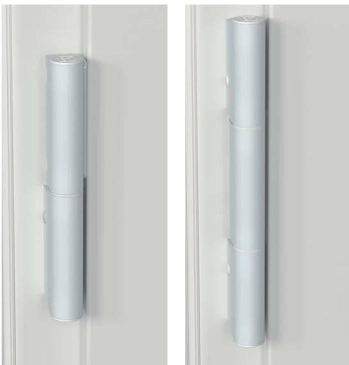
можность крепления петель только за одну стенку передней камеры профиля, то есть только в пластик, предварительно просверлив соответствующие отверстия и применив укороченные штифты и самонарезные винты. При таком креплении дверной петли максимальный вес створки не должен превышать 80 кг.
