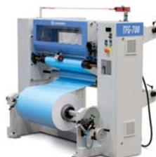
индивидуально регулируемых ножей. Станок усовершенствован автоматической перемоточной станцией для новых рулонов, боковой регулировкой положения рулона, системой быстрой загрузки и выгрузки рулона, регулируемым пневматическим тормозом и счетчиком метров.
