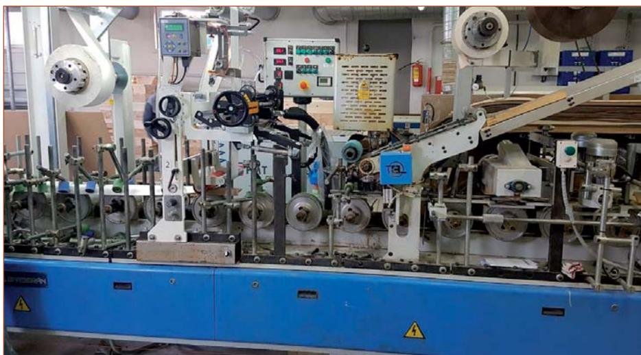
Переоборудование компанией «Экстру-Тех» ламинатора Barberan на ПУР-систему
