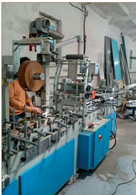
Переоборудование компанией «Экстру-Тех» ламинатора FUX на ПУР-систему
