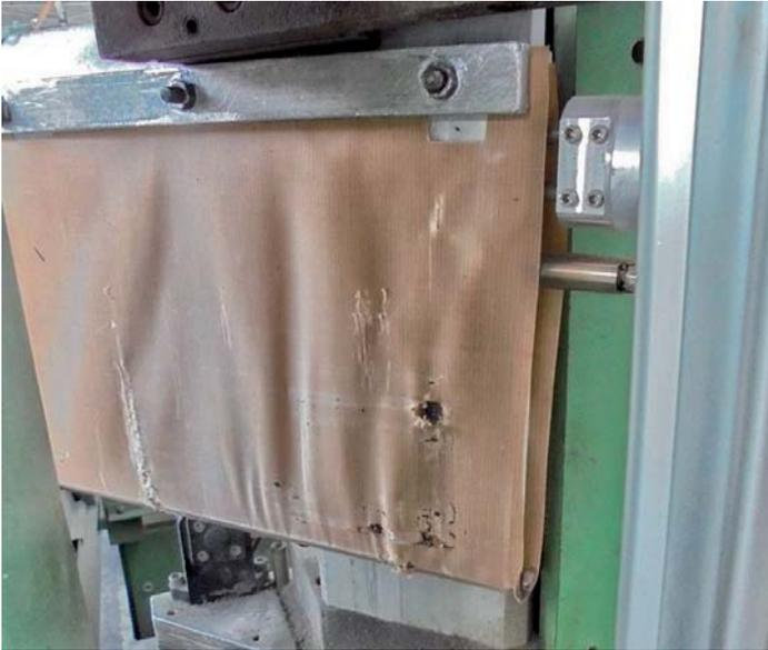
*Работа с поврежденной тефлоновой лентой ведет к низкому качеству сварного шва*
