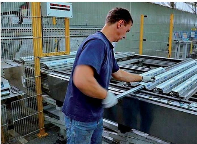
*Установка армирования на обрабатывающем центре, крепление армирования производится автоматически в специальном модуле центра*
