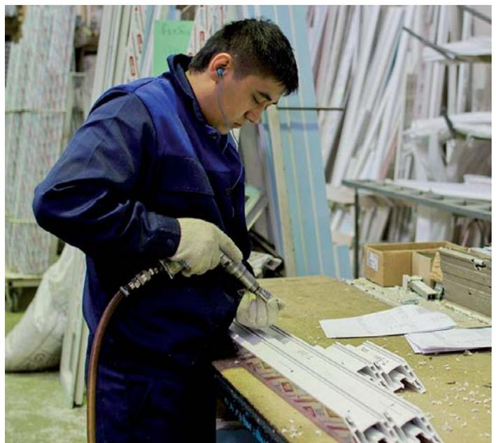
*Крепление армирования на рабочем столе*
