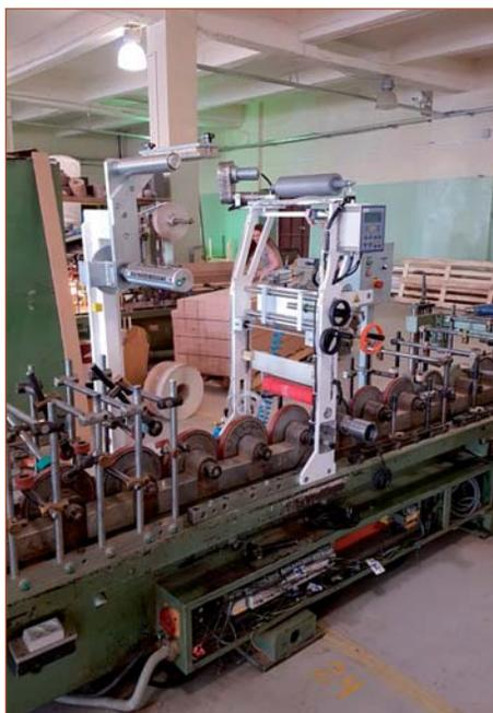
Переоборудование компанией «Экстру-Тех» ламинатора FRIZ на ПУР-систему
