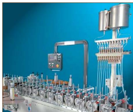
Система автоматизированной подачи праймера на станке
