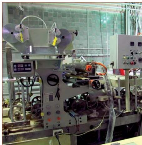
На представленных ниже фотографиях китайский ламинационный станок с шириной ламинации до 900 мм, переделанный под ПУР-систему. Ламинатор работает в составе экструзионной линии.
