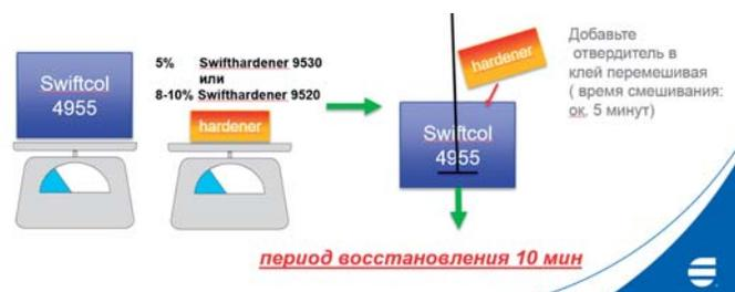
Процесс ламинирования должен тщательно контролироваться на всех этапах. После окончания всего процесса и спустя некоторое время на каждой партии производятся испытания на отрыв пленки и пробное угловое сваривание. Ламинированный профиль необходимо хранить при температуре не ниже 18°C. Сваривание либо же нарезку ламинированного профиля можно производить не ранее чем через 72 часа после процесса ламинации. Изгиб профиля для производства арочных конструкций допускается осуществлять через 14 суток.
