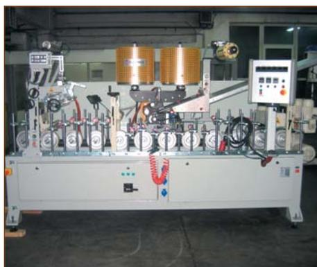
Станок для ламинирования с использованием EVA и PUR
