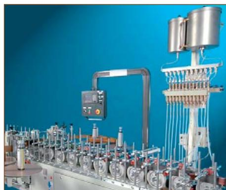
Система автоматизированной подачи праймера на станке
