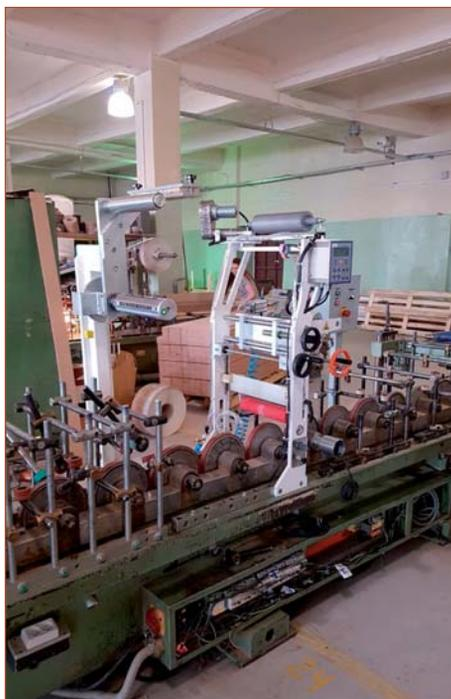
Переоборудование компанией «Экстру-Тех» ламинатора FRIZ на ПУР-систему
