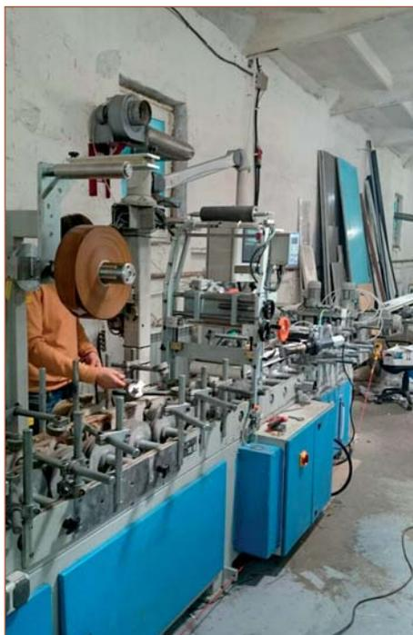
Переоборудование компанией «Экстру-Тех» ламинатора FUX на ПУР-систему
