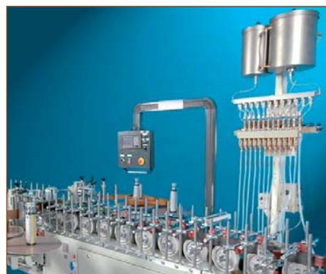
Система автоматизированной подачи праймера на станке
