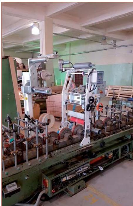
Переоборудование компанией «Экстру-Тех» ламинатора FRIZ на ПУР-систему
