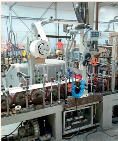
Переоборудование компанией «Экстру-Тех» ламинатора китайского производства на ПУР-систему
