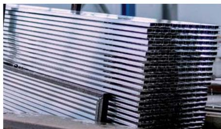
Тип фасада — стоечно-ригельный, т. е. профиль ригеля стыкуется с профилем стойки внахлест, с обработкой выступа на торце ригеля; это позволяет обеспечить гарантированный отвод влаги. И ригель-ригельный, т. е. профиль ригеля стыкуется с профилем стойки встык, без обработки выступа на торце ригеля.
