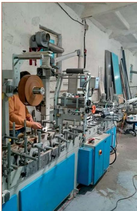
Переоборудование компанией «Экстру-Тех» ламинатора FUX на ПУР-систему
