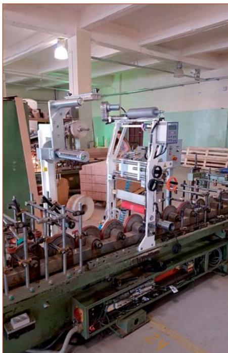
Переоборудование компанией «Экстру-Тех» ламинатора FRIZ на ПУР-систему
