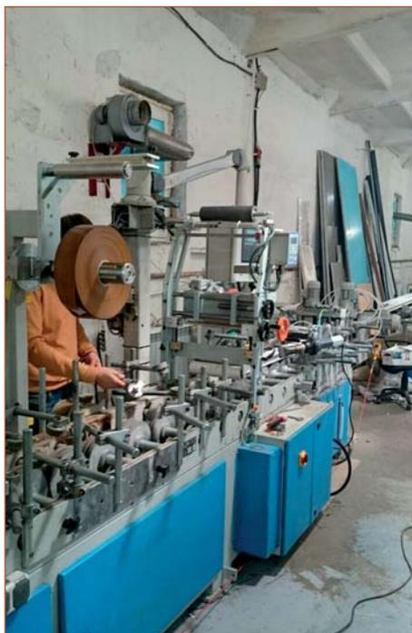
Переоборудование компанией «Экстру-Тех» ламинатора FUX на ПУР-систему
