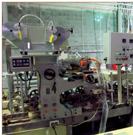
На представленных ниже фотографиях китайский ламинаторный станок с шириной ламинации до 900 мм, переделанный под ПУР-систему. Ламинатор работает в составе экструзионной линии.
