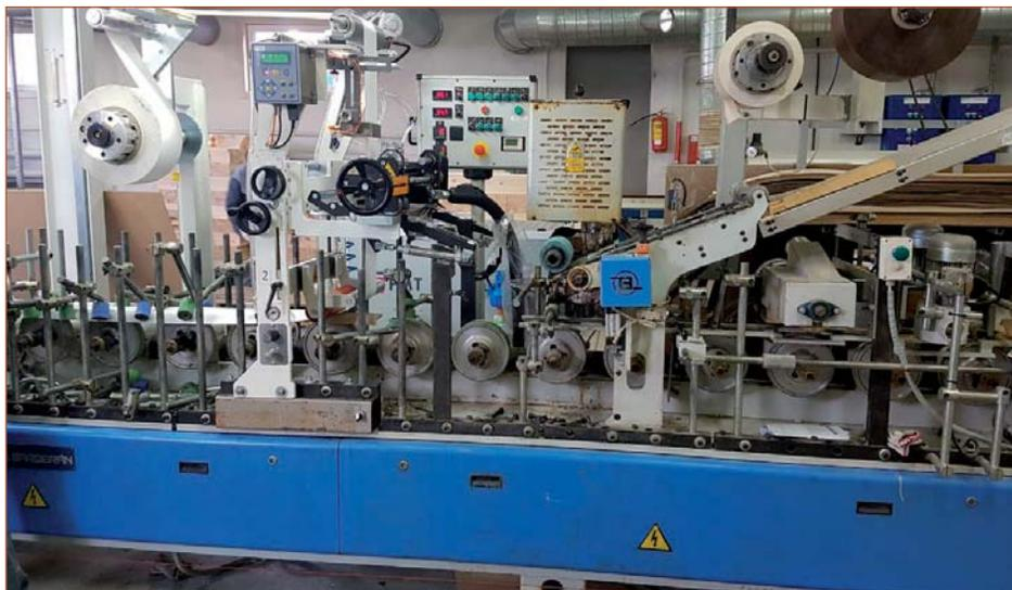
Переоборудование компанией «Экстру-Тех» ламинатора Barberan на ПУР-систему
