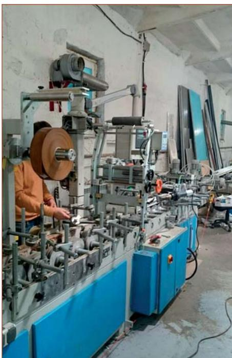
Переоборудование компанией «Экстру-Тех» ламинатора FUX на ПУР-систему
