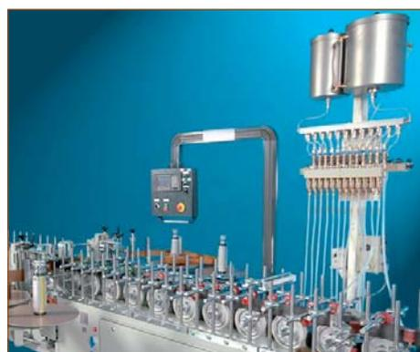
Система автоматизированной подачи праймера на станке
