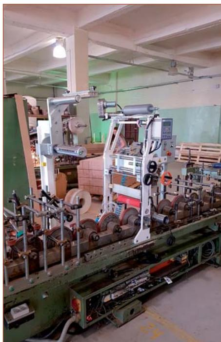
Переоборудование компанией «Экстру-Тех» ламинатора FRIZ на ПУР-систему
