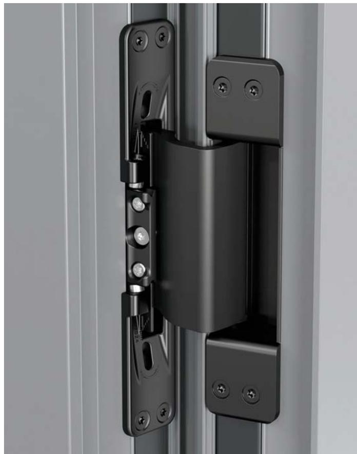
актуальной версии скрытой петли, максимальный угол открывания VL-Band AT составляет  $105^\circ$ . При монтаже дверного элемента производитель дверей должен обязательно предусмотреть установку ограничителя открывания створки.
