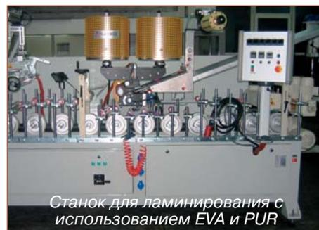
Станок для ламинирования с использованием EVA и PUR
