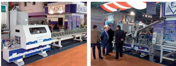
Линия работает в автоматическом режиме и с использованием клеев ПУР и ЭВА. Уникальность линии заключается в нанесении ПУР-клея через роликовый аппликатор, что делает возможным окучивание листового шпона полиуретановыми клеями.
