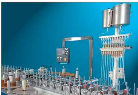
Система автоматизированной подачи праймера на станке
