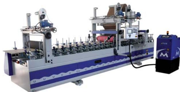
Станок укомплектован плавильной системой фирмы «Мелтон» (Испания) для плавления и нанесения клея-расплава. Максимальная ширина нанесения клея 550/850/1100/1300 мм.
