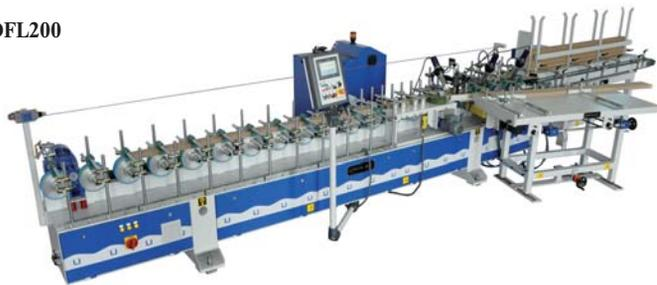
Автоматическая линия для производства наличников с использованием клеев ПУР, ЭВА и полиолефина. Наличники изготавливаются путем приклеивания двух заготовок под углом 90° с дальнейшей фрезеровкой углов под требуемый радиус. Также возможно совмещение ламинирующего станка в единой линейке. Производительность линии около 40 м/мин.
