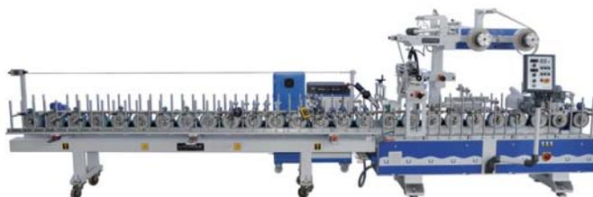
Ламинирующий станок для МДФ-профилей с использованием термоплавкого клея-расплава ПУР (PUR) со сменной кассетной конструкцией. Имея несколько кассет, можно настраивая одну из них, параллельно работать на второй станине окучивания.
